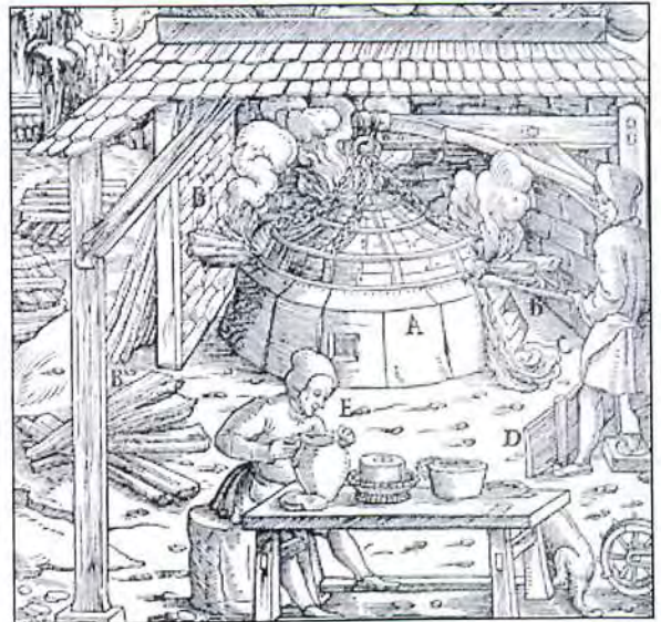
Rechts: Treibofen (A). Bei (C) zieht der Meister mit einem Glätthaken die Silberglätte – richtiger Bleiglätte ab. Agricola 1556 (E) – „Der sylberbrenner isset butyr (Butter) daß ihm das Gifft/welchs der tiegel von sich gibet nicht schad/dann es ist eine sonderliche artzney widers gift“
