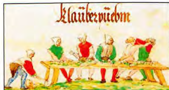
Links: Scheidetechnik im 18. Jahrhundert: Klaubarbeit, Scheid- und Setzarbeit Oben: Buben am Klaubtisch; Schwazer Bergbuch von 1554
