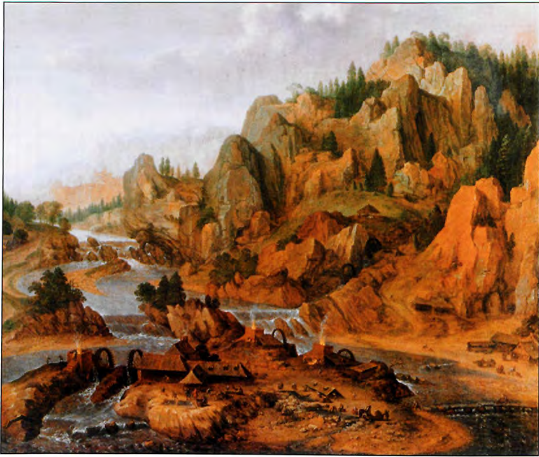
Gebirgslandschaft mit Berg- und Hüttenwerk, Claes Dirckz. van der Heck, frühes 16. Jahrhundert. Rechts im Bild Aufbereitungsanlage mit Setzfass und Scheidebank; Bildmitte: Seigerhütte mit Schachtöfen, mit Wasserrad angetriebenen Blasebälgen, das vierte Rad treibt ein Pochwerk an.
