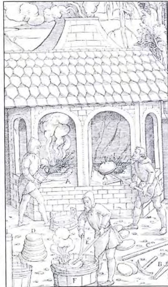
Rechts: Garherd: Nachdem das Schwarzkupfer zu Garkupfer geläutert wurde, wird es in Scheiben herausgerissen; Agricola 1556
