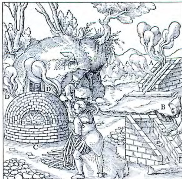
Rechts: Ein brennender Röststadel mit Bleierz und daraufgelegten Hölzern (A). Ein Arbeiter trägt auf einen Röststadel Bleierz ein (B). Der dem Backofen ähnliche Röstofen (C); Agricola 1556
