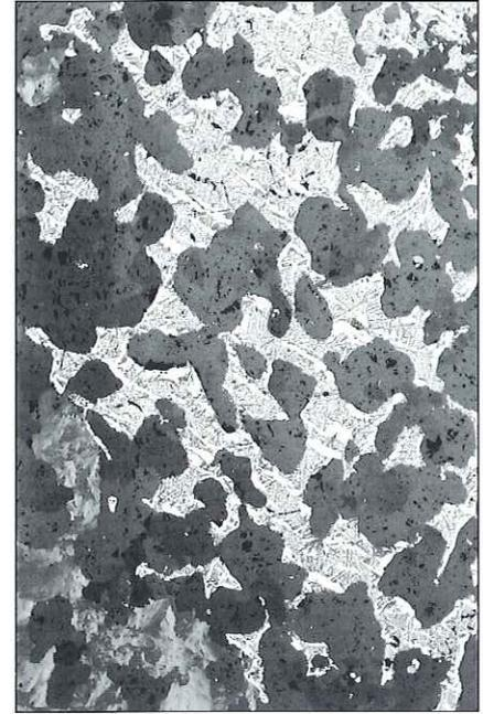
Rechts: Nukundamit (dunkel) inmitten von Chalkopyrit (hell), daneben Covellin (links unten); Erasmus. Erzmikroskopisches Anschliffbild, BB: 1,5 mm. Foto: Paar.
