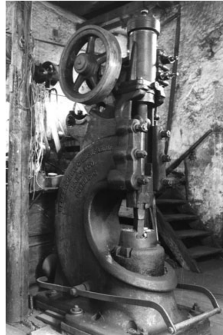
Der Schmiedehammer wurde durch Wasserkraft angetrieben und machte einen Höllenlärm
