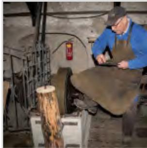
Per Hand wird das Messer nach dem Schleifen abgezogen. . .
