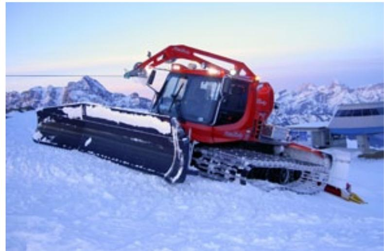
Pistenpräparierung mit Windeneinsatz in steilem Gelände
