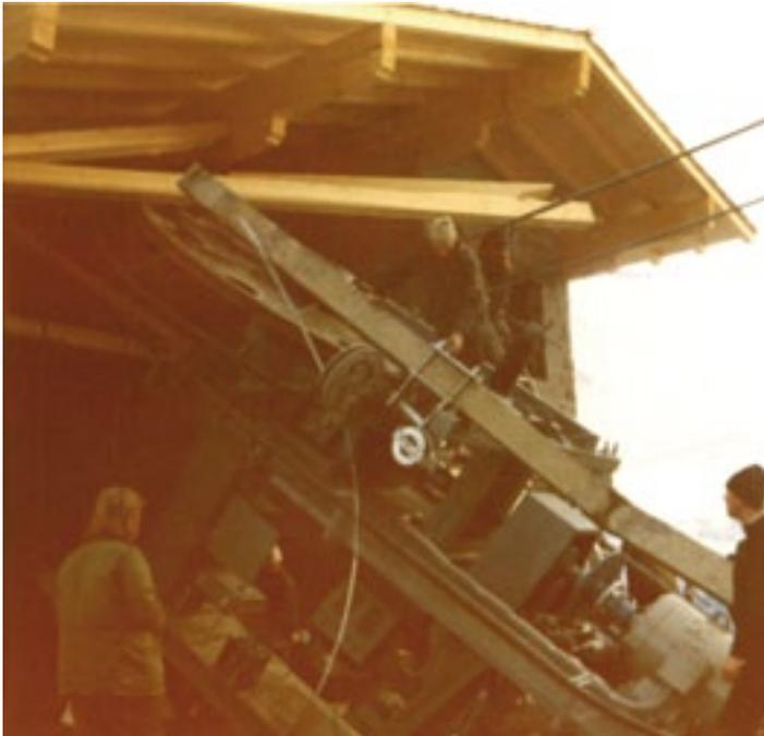
Abgestürzte Antriebsgruppe nach Seilriss des Spannungsgewichtes
